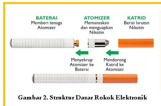
Gambar 2. Struktur Dasar Rokok Elektronik
